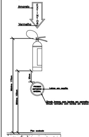
A fixação do aparelho deverá ser instalada com previsão de suportar 2,5 vezes o peso total do aparelho a ser instalado
